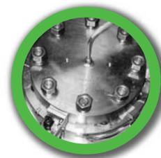
Im Rahmen dieses Gesamtkonzepts kommt den rechnerischen Nachweisen eine zentrale Bedeutung zu. Für die Berechnung von Flanschverbindungen bietet **amtec** analytische Verfahren nach DIN, KTA, ASME, EN sowie detaillierte FE-Berechnungen. Hierbei können sowohl Flanschverbindungen mit der Dichtung im Krafthauptschluss als auch Verbindungen mit der Dichtung im Kraftnebenschluss bearbeitet werden.
